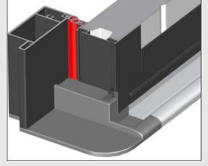
Joint d'étanchéité tubulaire EPDM côté ouverture
