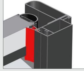
Joint tubulaire à lèvre EPDM côté fermeture
