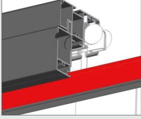
Joint d'étanchéité EPDM sur linteau
